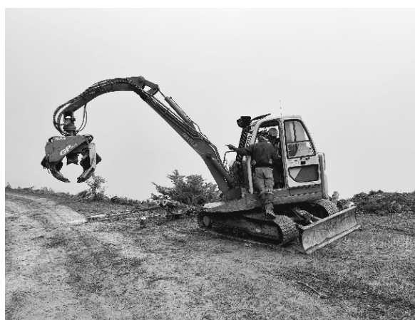
図5 スイングヤーダーによる玉切り
